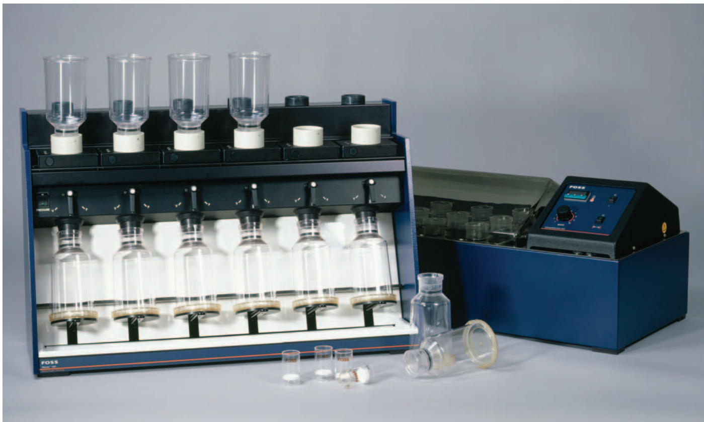
Sistema semiautomático de incubación y filtración para la determinación cuantitativa de fibra dietética* en alimentos, cereales, frutas y verduras.
